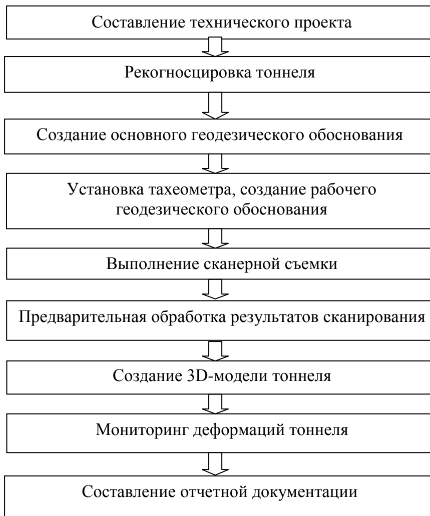
Рис. 1. Обобщенная технологическая схема наземной сканерной съемки для мониторинга железнодорожных тоннелей
