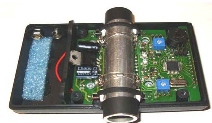
Рис. 4. Хронограф «Хрон-53Т» (внутренняя компоновка)
