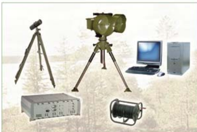
Рис. 3. Радиолокационная станция «Луч 83-М1»
