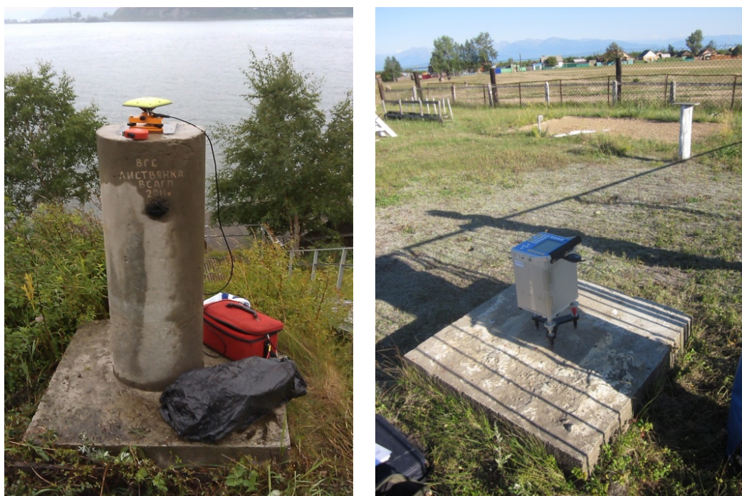
Рис. 1. Спутниковые наблюдения на пункте ВГС «Листвянка» и гравиметрические определения на пункте «Нижнеангарск»
