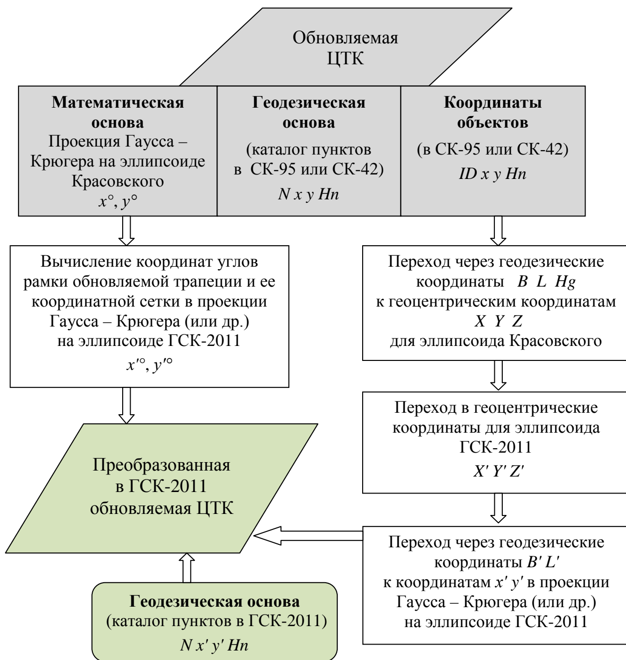
Рис. 1. Принципиальная схема методики преобразования обновляемой ЦТК из систем координат СК-95 (СК-42) в СК-2011
