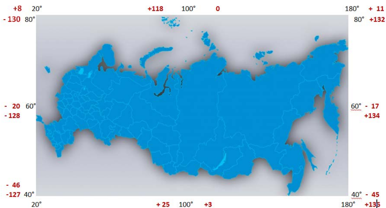
Рис. 4. Значения изменений координат точек объектов для территории Российской Федерации при переходе от СК-42 (СК-95) к ГСК-2011
