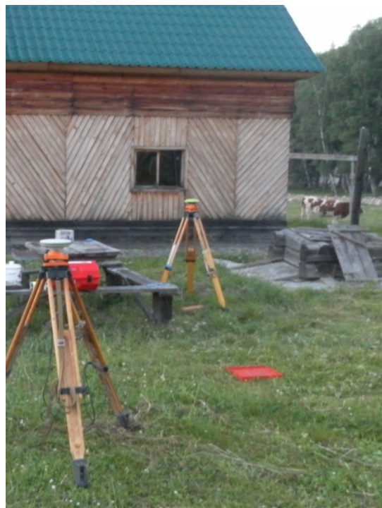
Рис. 5. Установка ГНСС-аппаратуры на пункте T1 (Leica Viva GS10) и на пункте J1 (Javad SigmaQ G3T)
