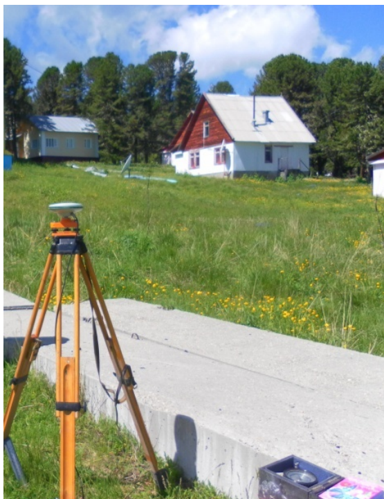
Рис. 4. Установка ГНСС-аппаратуры на пункте SEMI (Leica Viva GS10)
