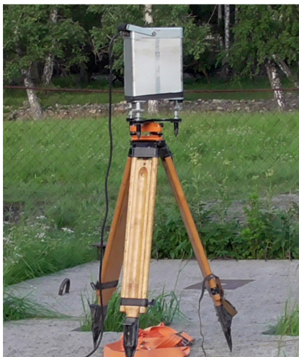
Рис. 3. Измерение аномального вертикального градиента силы тяжести на пункте N100001 (с. Шебалино)
