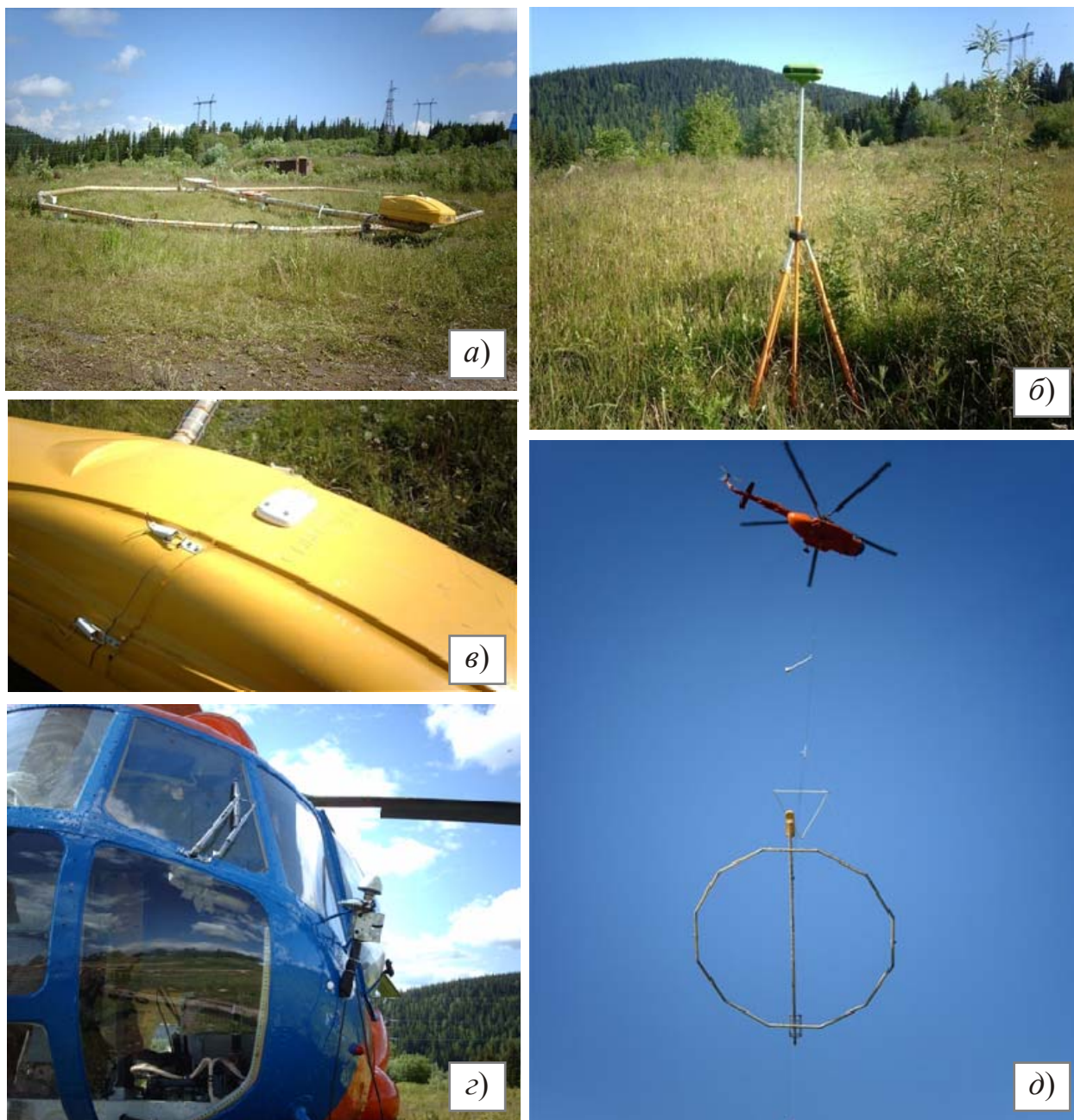
Рис. 2. Размещение антенн спутниковых приемников на электромагнитном комплексе «Импульс-Аэро»:
