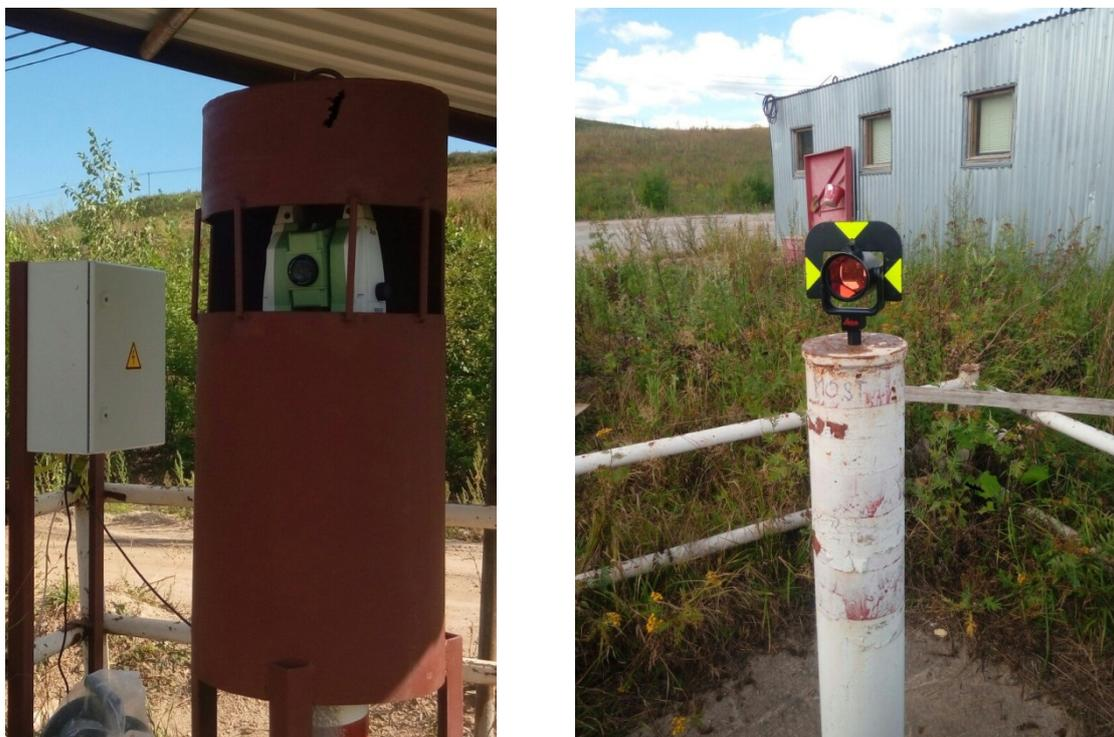
Рис. 3. Автоматизированный тахеометр и опорный отражатель
