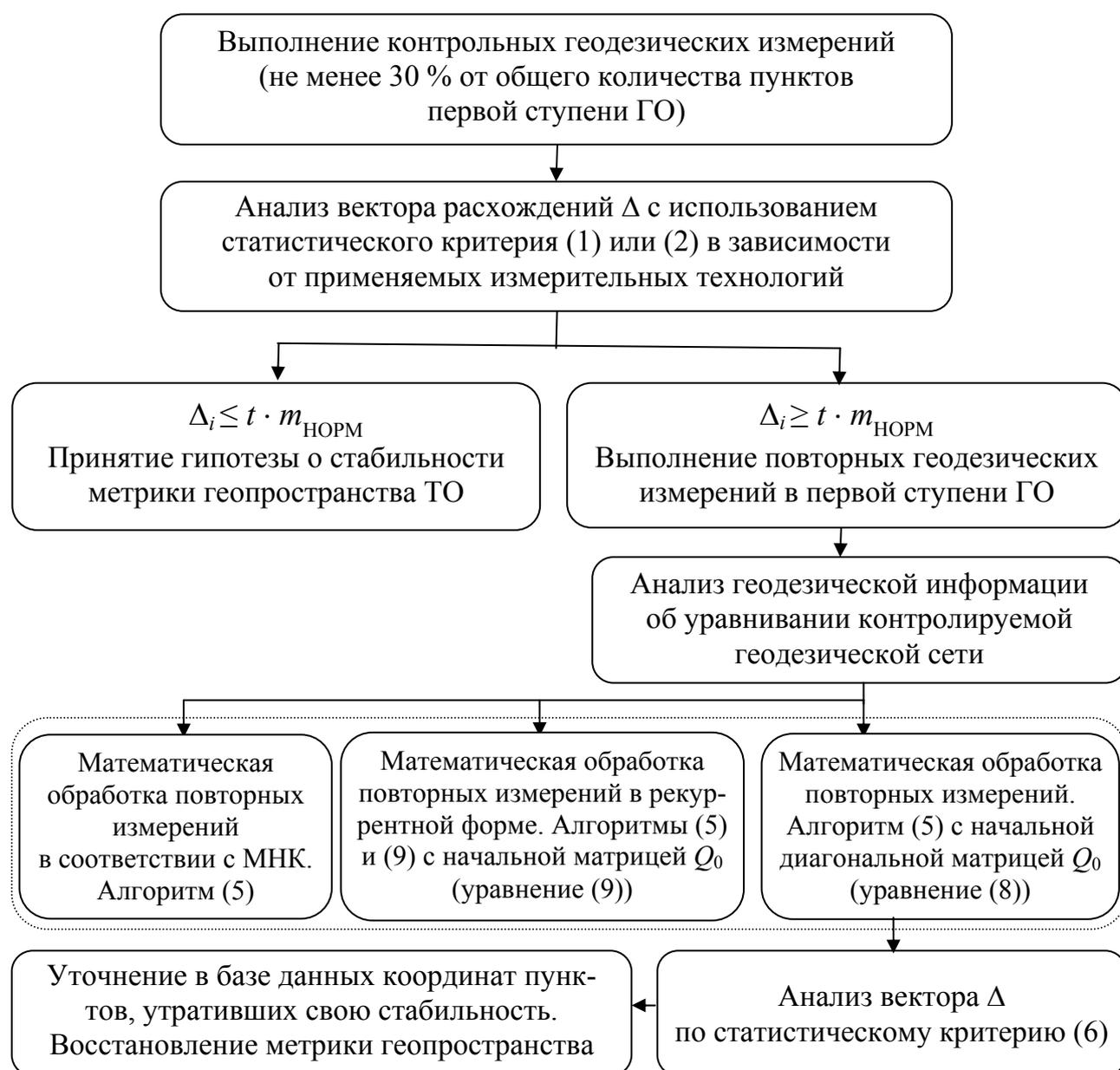
Технологическая схема определения стабильности пунктов геодезического обоснования в территориальном образовании
