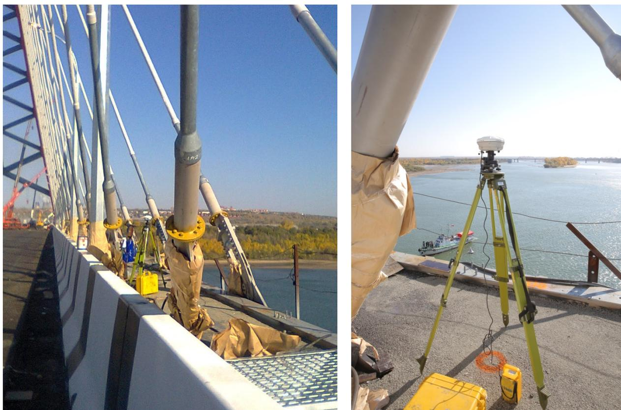
Рис. 4. Спутниковый приемник на точках  $S_H$  (слева) и  $S_B$  (справа)
