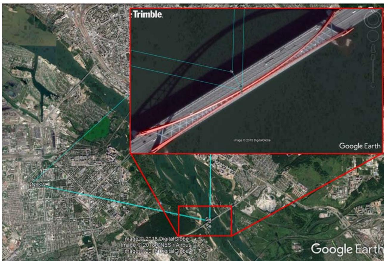
Рис. 7. Схема измерения векторов от базовых станций
