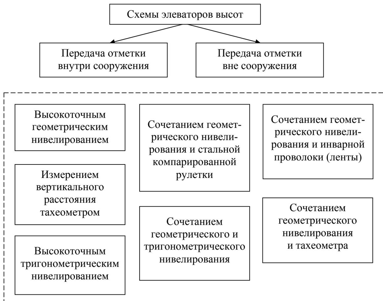
Рис. 1. Схемы создания элеваторов высот
